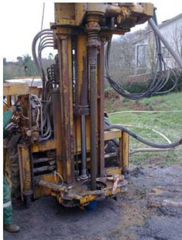
Perforación geotérmica vertical a 140 m de profundidad con 2 sondas de doble U y tubo de inyección de la mezcla geotérmica
